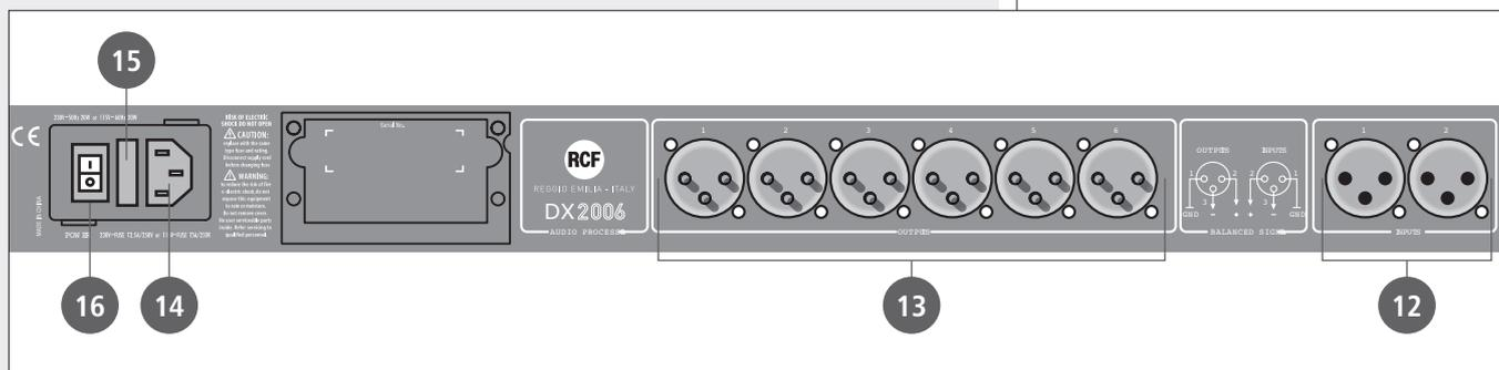
**12 INPUTS** – Аудио (аналоговые) балансные входы (3-контактные гнездовые разъемы XLR). **13 OUTPUTS** – Аудио (аналоговые) балансные выходы (3-контактные разъемы XLR).
