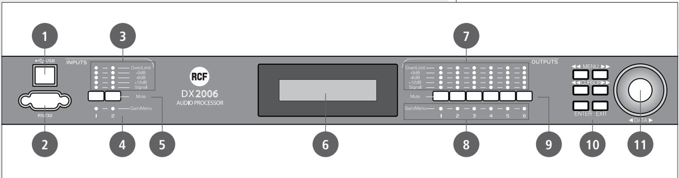
1 USB-порт (тип B) для подключения к ПК. Необходимо установить драйвер (с прилагаемого компакт-диска с программным обеспечением).
